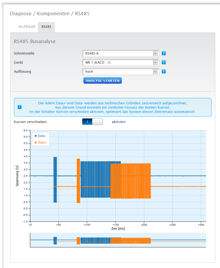
Abb.: Beispiel einer RS485-Busanalyse (bei aktiviertem Installationsmodus)
