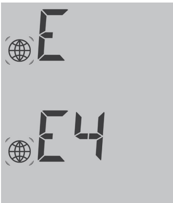
Abb.: Beispiel Blinkcodes für Internet - Fehler 4
