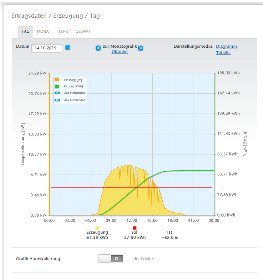
Abb.: Diagramm Tages-Ansicht Erzeugung mit deaktivierter Autoskalierung
