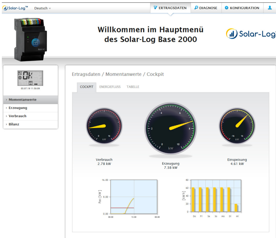
Abb.: Hauptmenü Solar-Log Base 2000
